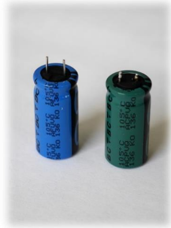
1. ábra A jobb oldali kondenzátor már elszíneződött
