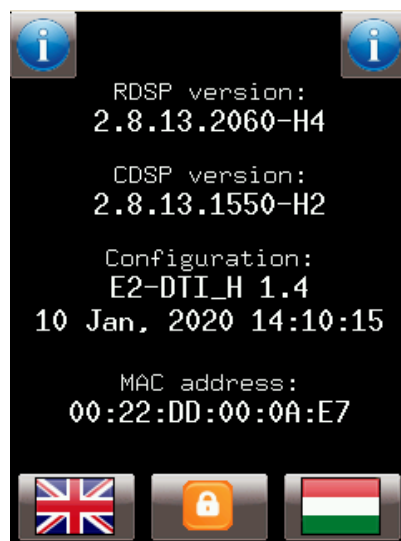
Figura 5-7 Informatii RDSP, CDSP si de configurare pe ecranul LCD
